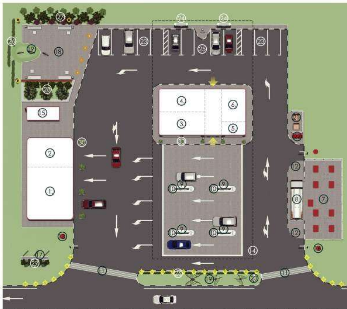
Тип 2. Схема планировочной организации автомобильно-заправочного комплекса
